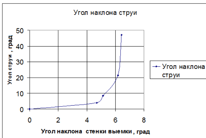
Рисунок 3. График зависимости угла струи от угла выемки а - график изменения угла наклона струи, выходящей на поверхность раздела шлак – сталь; б – картина движения потоков стали в приемной камере ковша
